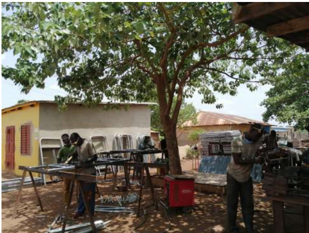
Fabrication des lits: soudure des portiques
